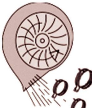
Shot-peening 喷丸处理
